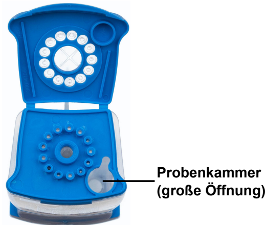
Abbildung 5. Xpert Xpress CoV-2/Flu/RSV plus-Kartusche (Draufsicht)
