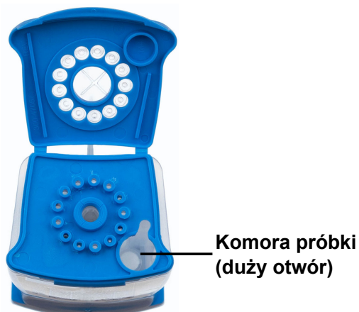
Ilustracja 5. Xpert Xpress CoV-2/Flu/RSV plus Kartridż testu (widok z góry)
