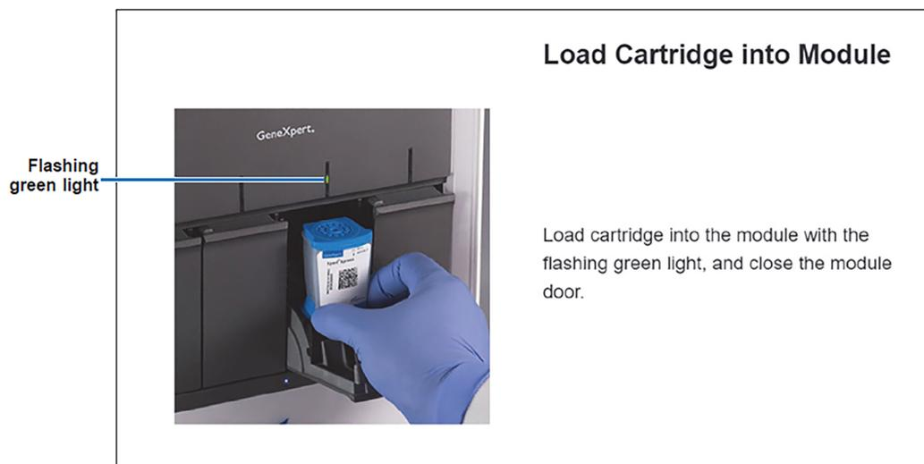
Figure 29. Écran Charger la cartouche dans le module (Load Cartridge into Module)
