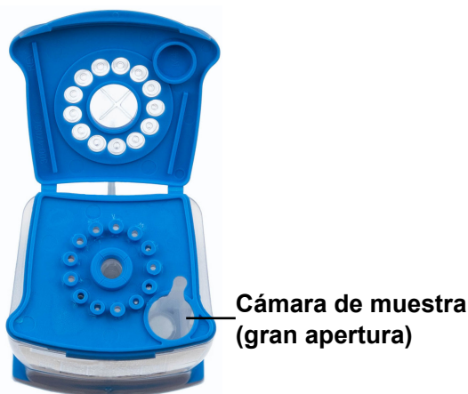
Figura 5. Xpert Xpress CoV-2 plus Cartucho de (vista superior)
