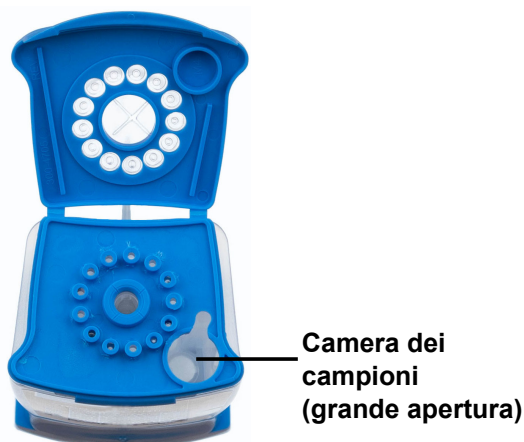
Figura 5. Cartuccia Xpert Xpress SARS-CoV2 (vista dall'alto)
